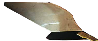
ЦИЛИНДРИЧЕСКИЙ УДЛИНЁННЫЙ ОТВАЛ P (ОТ 20 ДО 35 СМ)
