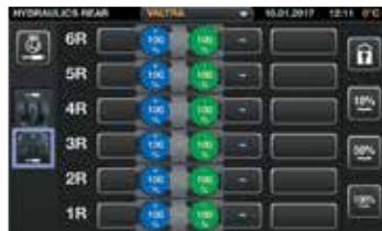
Вы можете управлять любой гидравлической функцией, включая гидравлические секции (передние и задние), заднюю и переднюю навесные системы или фронтальный погрузчик.
