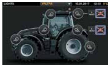
Удобная регулировка рабочего освещения через терминал. Выключатели рабочего освещения и проблескового маячка на подлокотнике.
