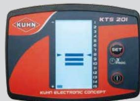
**Контроллер KTS 201** (только для HD TRONICO) отображает глубину обработки в кабине оператора.
