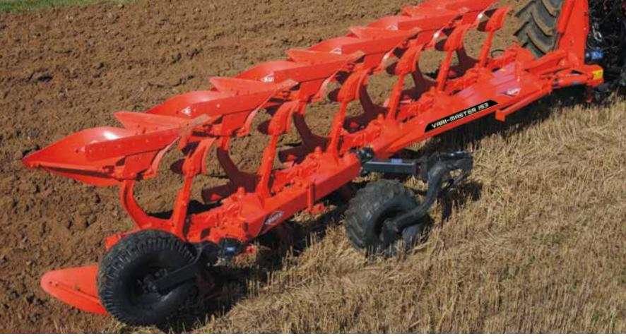
Колесо закреплено на вертикальной оси, которая позволяет следовать всем изменениям рабочей ширины.
